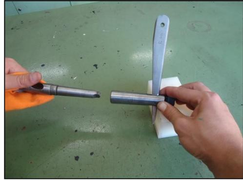
Para ajustar a broca de haste cônica na bucha de redução é muito simples e depois de ajustada é só fixá-la no mangote. Veja que a bucha possui as mesmas dimensões externas e o formato da haste do mandril. Isso quer dizer que após montarmos a broca na bucha será fácil ajustá-la no mangote.
