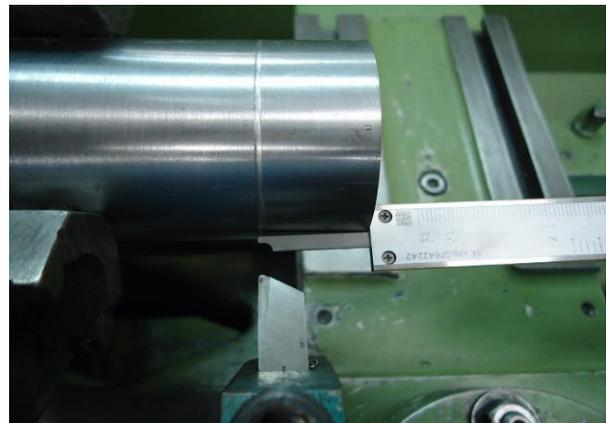
**7º - Passo:** Com o **torno ligado**, toque **novamente** na extremidade do material e de forma mais sutil, ou seja, somente até tocar levemente na peça, coloque o zero do anel graduado em sua referência. Reire a ferramenta pelo carro principal sem afasta - lá, isto é, deixe o anel no zero.
