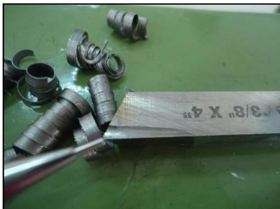
Lembrando que neste caso a geometria de corte da PASTILHA INTERCAMBIÁVEL (abaixo) foi transferida para a ferramenta, ou seja, o detalhe responsável pela QUEBRA DO CAVACO foi aplicado no ESMERIL durante a afiação do BITS, conforme demonstrado abaixo. **Cuidado:** o uso de ferramentas que geram cavacos com formato de fitas podem ocasionar GRAVES ACIDENTES.
