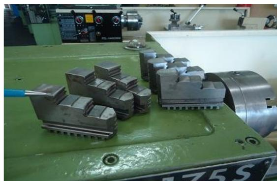
Abaixo vemos a castanha sendo montada para a fixação de eixos como disse usa-se este jogo para a fixação de peças até um **determinado diâmetro**.
