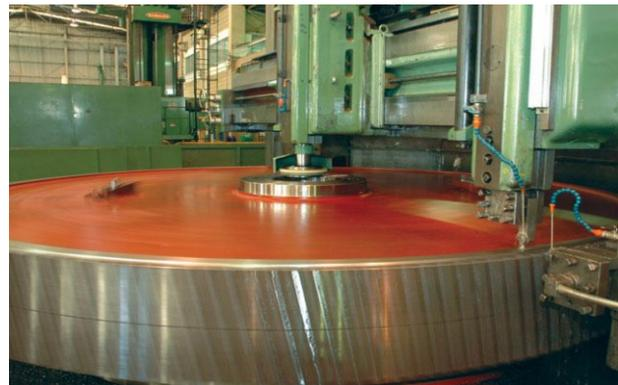
Aqui temos uma peça sendo preparada para o torneamento no **diâmetro interno** no TORNO VERTICAL (aproximadamente 5 metros de diâmetro) externo.
