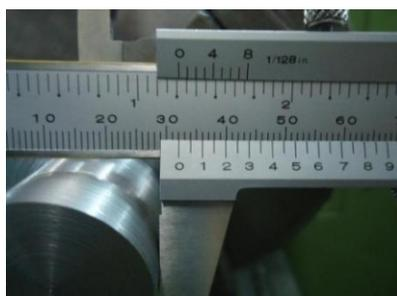
O paquímetro que além de ser o instrumento mais utilizado em todo mundo, foi projetado para obter com precisão medidas nas quatro situações mais comuns que existem, são elas; medidas EXTERNAS – INTERNAS – PROFUNDIDADE e RESSALTO
