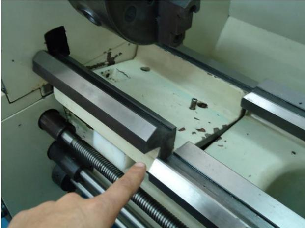
Uma vez retirados os parafusos de fixação, a Cava está solta.
