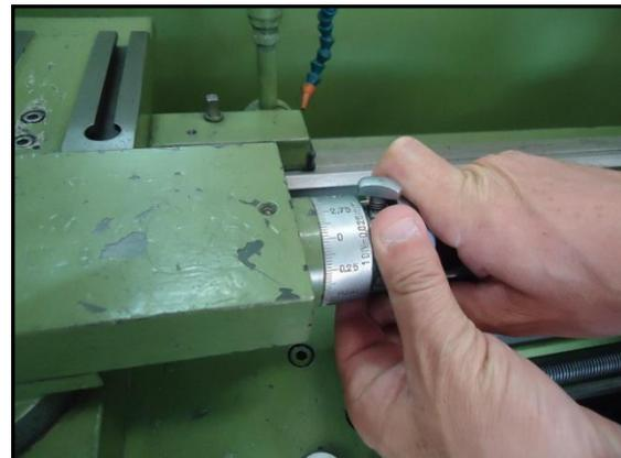
**ATENÇÃO - Para o DESBATE do rebaixo, mantenha a ferramenta reta até chegar próximo às medidas do acabamento independente se for wídia ou bits, ou até mesmo uma ferramenta intercambiável.**
