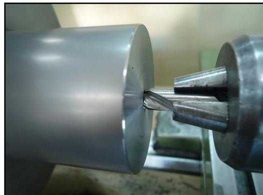
**12º Passo** – Verifique o diâmetro do furo de centro até obter a medida (D) especificada no desenho, ou conforme a norma ISO 866 (NORMA sobre dimensões de furo de centro). Na prática, quanto maior for a peça, maior será o diâmetro do escareado. Na verdade depois de um tempo você acostuma a analisar o perfil e o tamanho do furo de centro.
