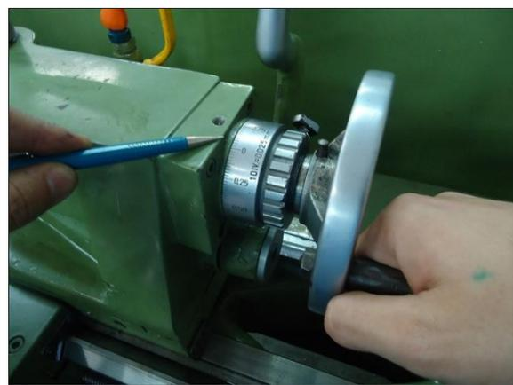
**ATENÇÃO** - Afaste o cabeçote móvel, limpe o furo e verifique a profundidade do furo com a haste de profundidade do paquímetro.
