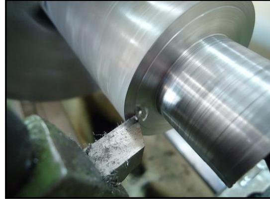
Tornear rebaixo é a operação em que controlamos duas medidas: o **diâmetro e o comprimento**. Como já aprendemos **tornear o diâmetro**, agora vamos repetir o aprendizado anterior e incrementar uma nova operação que é controlar o comprimento de um corpo da peça; então vamos nos acostumando com os termos técnicos. Rebaixo é a união das medidas de diâmetro e comprimento.
