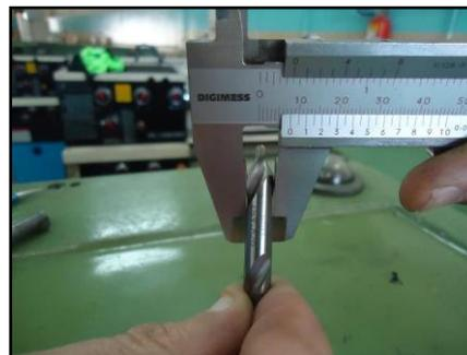
Obs.: As dimensões do furo vão depender diretamente das dimensões do eixo que será trabalhado. Na prática, peças pequenas terão furos pequenos e conforme aumenta seu diâmetro e comprimento, o furo de centro também será maior, sendo necessário a troca de broca por uma maior aqui vamos usar uma broca de Ø8,00m.
