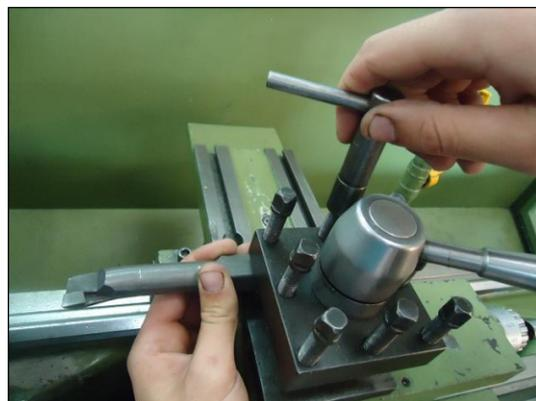
Outra particularidade em relação a fixação da ferramenta é que no torneamento externo aprendemos a usar a ponta rotativa como referência para alinharmos a ferramenta na altura de centro, para o torneamento interno também podemos usar o mesmo processo e verificar a altura. **PORÉM...**
