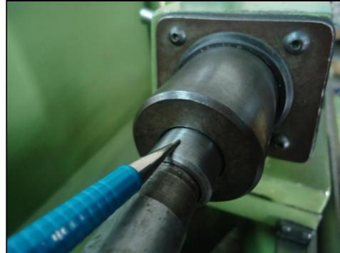
**Continuação dos comentários** - Porém muitas brocas não vão encaixar “acoplar” de imediato devido o diâmetro interno do mangote ser maior que o diâmetro da haste sendo necessário a adaptação com uma bucha de redução. Observe que existe grande folga entre o diâmetro da haste cônica da broca em relação ao diâmetro do furo do mangote que tecnicamente é chamado de diâmetro interno do “mangote.”
