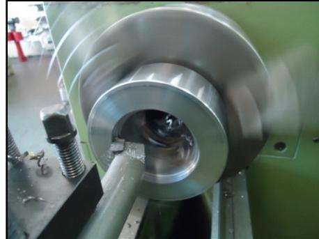
**PRECAUÇÃO II** – Fique atento com a formação do cavaco contínuo ,em formato de fita,se for necessário desligue o torno e retire os cavacos com o gancho apropriado.
