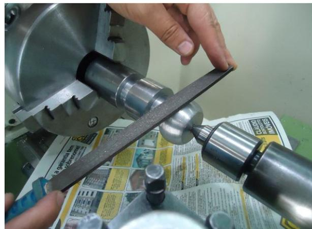
**6ª NORMA - Mantenha** o carro superior **sempre alinhado** quando não estiver utilizando-o. Deixá-lo desalinhado pode gerar uma situação de risco de impacto com as castanhas da placa.
