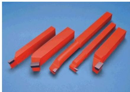
Nas tabelas são especificadas como ferramentas "carboneto metálico" assim como o Bits a variação da VC também pode ocorrer conforme a qualidade da "Marca" do fabricante.
