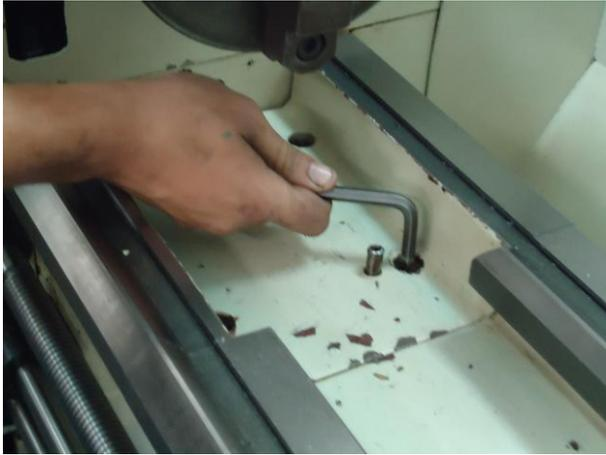
Desapertando os parafusos de fixação da cava
