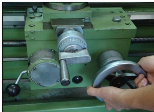
**2º Passo-** selecione a RPM, ligue o Torno Mecânico e inicie o torneamento com avanço manual
