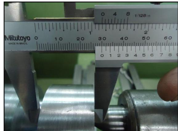
**14º PASSO** – Agora, vamos conferir a medida de abertura do canal “sangramento”, em nosso exemplo, 13,5 mm aproximadamente, desloque a ferramenta através do carro superior, toque na parede do lado esquerdo do canal, desloque 1,00mm e posteriormente os décimos.
