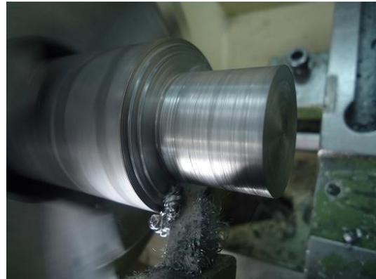
**9º Passo:** Verifique a medida do comprimento e do diâmetro para que possamos a partir deste momento iniciar o controle FINAL das duas medidas. Veja a forma criativa e correta de verificar a medida de comprimento. Este processo tem o nome de MEDIR POR RESSALTO é muito simples e facilita a leitura. Veja como seria complicado fazer a leitura através da haste de profundidade, pois os números ficam de cabeça para baixo.
