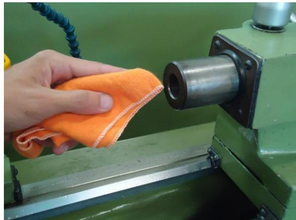
O mangote deve ficar fora do cabeçote no Mínimo duas vezes o seu diâmetro para facilitar a fixação da ponta rotativa. **Em outras palavras, deixe-o para fora** em média uma distância aproximada de 3 a 4 dedos como pode ser visto na foto abaixo, estando tudo certo, basta introduzir a ponta no mangote que o mesmo vai fixar automaticamente devido seu corpo ter o cônico em formato de cunha.
