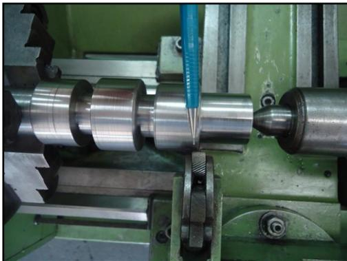
Apesar do diâmetro de uma superfície recartilhada não ser uma medida de precisão, temos que tornear o corpo com uma medida menor do que a que está no desenho. É que após recartilhar, o diâmetro vai aumentar devido o efeito da compressão das roldanas, outra observação é que com o torneamento antes de recartilhar vai contribuir para não haver balanço na peça, ou seja, que fique fora do centro.
