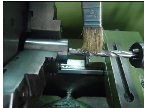
por isso é necessário retornar a broca ao ponto de origem para limpá-la retirando os cavacos, este procedimento é indispensável para que a broca possa ser refrigerada evitando o super aquecimento.
