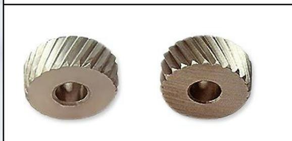
A Recartilha é montada no TORNO MECÂNICO e pressionada contra um material cilíndrico, em movimento rotativo, com isso cria-se sulcos na superfície da peça devido à deformação plástica do aço, como se estivesse sendo prensado.
