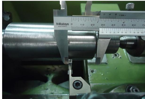
O eixo da ferramenta deve ficar perpendicular ao eixo do torno.
