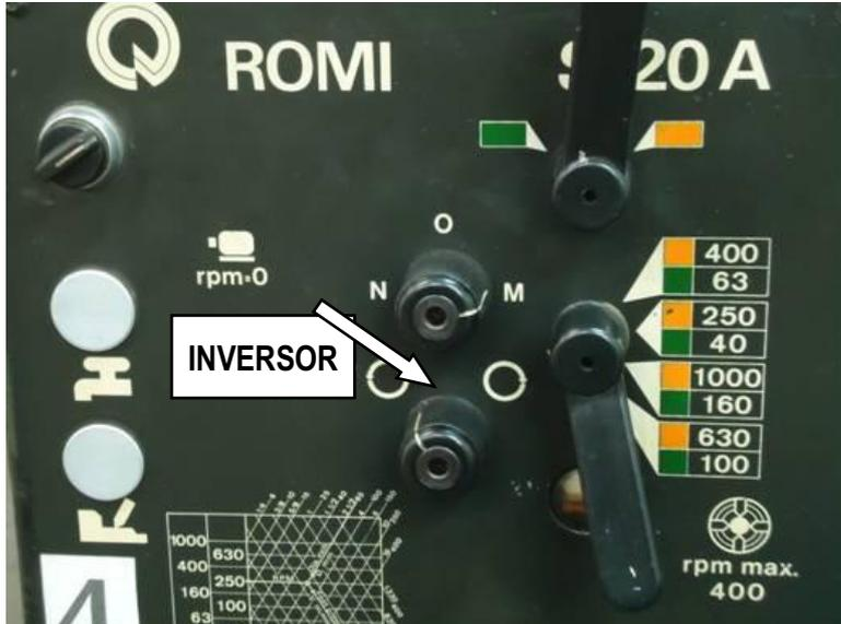
Neste modelo, a RPM é selecionada da mesma forma através das combinações de alavancas. Exemplo: vamos escolher **RPM 250** : leve a alavanca de cima até a cor **LARANJA** ( à direita ) e a alavanca de baixo posicionada sobre o **RPM 250** que está alinhado com a cor **LARANJA**. Na impressão preto e branco é verificado a direção das setas, ok?! Obs: não esqueça de engatar o inversor!
