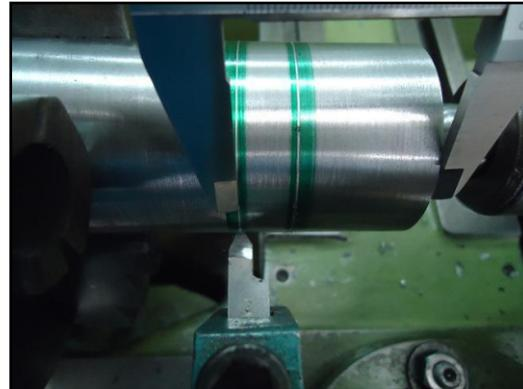
**ATENÇÃO!** Analise bem o desenho antes de traçar as linhas AUXILIADORAS, também chamadas de linhas de referências. Após a traçagem, posicione a ferramenta entre as marcas do canal, dê preferência para iniciar a usinagem no flanco “lado” direito do CANAL, visando controlar a medida de 31,00 mm.
