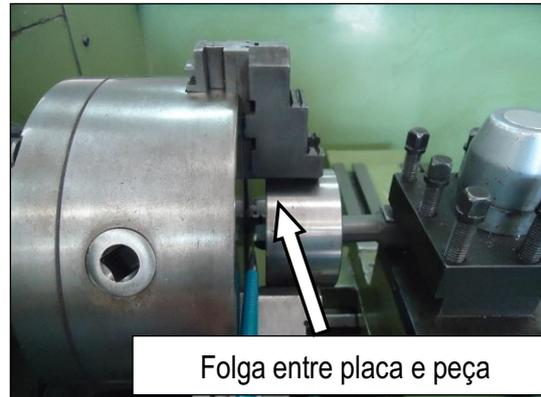
Ao fixar a peça mantenha **uma folga entre a face da placa** com uma distância suficiente para visualizar a saída da ferramenta no final do torneamento, lembrando que será por esta folga “fenda” que os cavacos sairão no momento do torneamento, portanto caso a peça seja fixada encostada na face vai dificultar a visão da ferramenta e também a saída dos cavacos.
