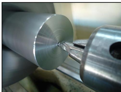
**7º Passo** - Aproxime a broca do material, deslocando o cabeçote móvel até próximo da face da peça.
