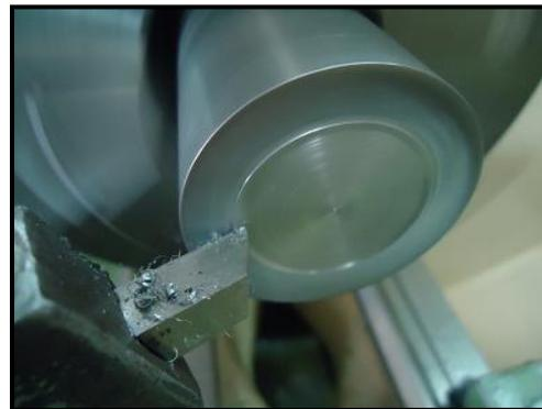
Obs- Como pode ser visto com o faceamento, o topo da peça fica com a superfície sem irregularidades.
