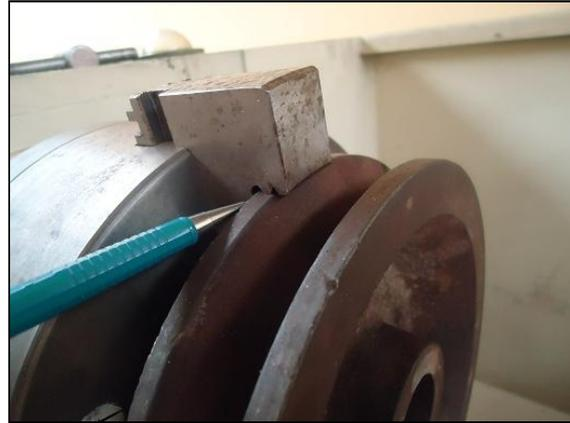
Saiba que as castanhas também podem ser usadas para a fixação de peças pelo furo, ou seja, internamente isso é possível devido os degraus RAIADOS no corpo da castanha, este processo é muito interessante, pois na verdade a peça é fixada "apertada", no sentido de desaperto, ou seja, abrindo a placa.
