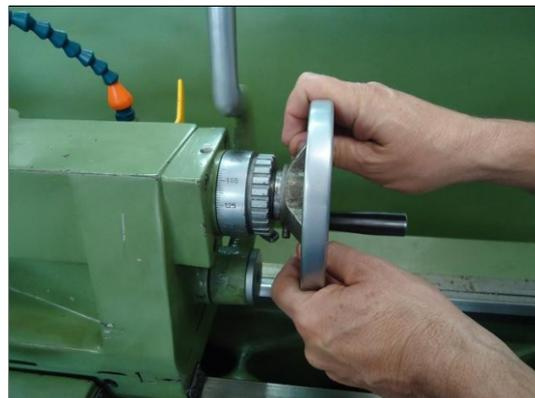
Use a refrigeração constantemente uma vez que para FURAR NO TORNO, a broca fica na posição horizontal dificultando que o REFRIGERANTE chegue até a ponta da broca. ATENÇÃO: - Caso seu TORNO não possua refrigeração automática, use uma garrafa plástica com furo na tampa e jogue o refrigerante. Nunca faça um furo SEM A REFRIGERAÇÃO, caso contrário você poderá queimar a ponta da broca devido o calor que é gerado no momento do corte.
