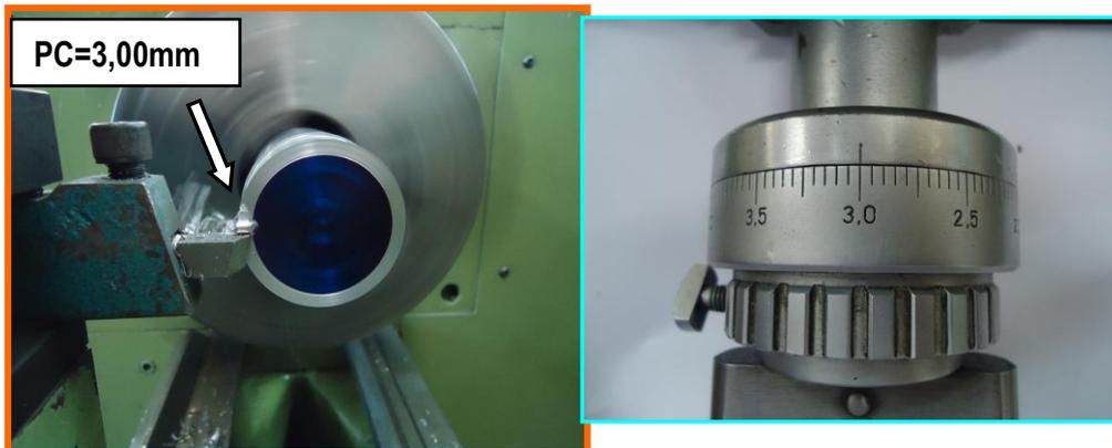
Da mesma forma ao analisar a foto abaixo, podemos entender que realmente a ferramenta penetrou **também 3,00mm** e também vai diminuir a medida de diâmetro da peça em 6,00mm. **Mas o anel já está convertido** para registrar o valor retirado no DIÂMETRO, entendeu?
