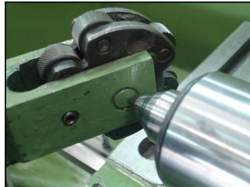
**2º PASSO:** O alinhamento da recartilha deverá ficar perpendicular a superfície que será recartilhada com as roldanas paralelas ao eixo, ou seja, com o suporte de frente para a peça.
