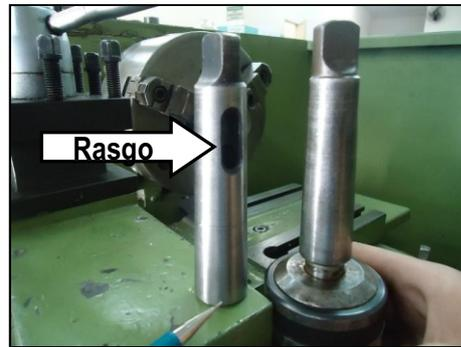
Alinhe a **espiga ao rasgo** da bucha e pressione que facilmente vão se encaixar e se ajustarem.
