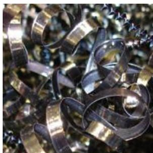
Com uma afiação adequada, em outras palavras, com um **raio menor**, fechamos à combinação perfeita para a melhoria do acabamento da superfície. Mas vale lembrar que evidentemente a PC (Profundidade de Corte) é de décimos de milímetros, ou seja, 0,1mm a 0,3mm no máximo, ou seja, de 2 décimos a 6 décimos no diâmetro.
