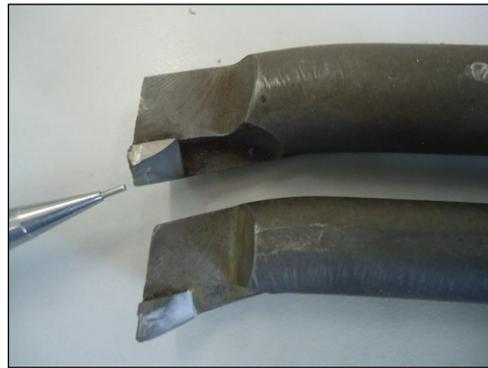
Veja que a ferramenta é fixada no quadrante de dentro do castelo conforme as fotos. No início do aprendizado parece ser diferente de tudo no que se refere a fixação de ferramentas.
