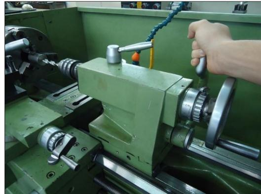
**Precaução:** Evite iniciar o furo com o mangote muito para fora do cabeçote, a distância ideal é em média comparada a dois dedos do operador, sendo assim só trave o cabeçote após verificar estas distâncias de aproximação da broca até a face e o comprimento do mangote.
