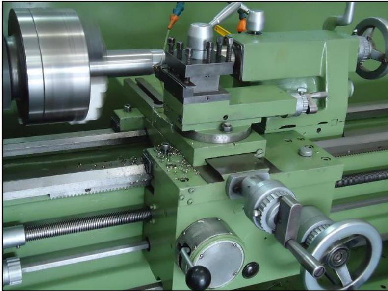
TORNEAR COM AVANÇO AUTOMÁTICO, em palavras simples é quando a ferramenta se desloca sem a interferência do operador, o carro principal é devidamente engatado e vai se movimentar sozinho.
