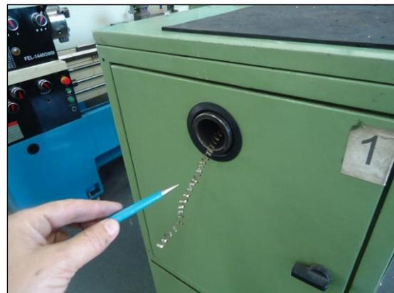
Outro problema originado pelo cavaco contínuo é a **quebra da ponta** da ferramenta, mesmo que esta tenha gavião, o “quebra cavaco” é necessário assim como a seleção correta da RPM e do AVANÇO e PC. Os cavacos que ficam dentro do furo vão **roçar** na ponta da ferramenta fragmentando-a levando o operador à constante afiação da ferramenta.
