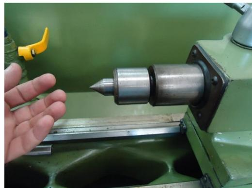
**3º PASSO** -Verifique a altura de centro “alinhamento” da ponta da ferramenta com a ponta rotativa. Caso esteja abaixo da ponta, utilize calços para regulagem da altura. Quando a ponta da ferramenta estiver acima do centro será necessário a troca da ferramenta, assim como do suporte.
