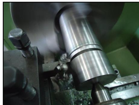
O importante é você não ficar desligando o torno para medir a todo o momento, isso nunca! Desligue o torno e confira a medida que deve estar próximo de  $32,00\text{mm}$ .
