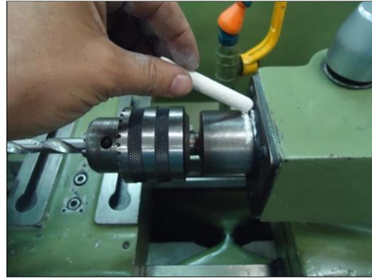
Com a broca na face do material, basta fixar o paquímetro na medida desejada e posicioná-lo no cabeçote móvel, conforme demonstra a foto abaixo e dar seqüência à furação deslocando o volante até que a marcação chegue na orelha do paquímetro.
