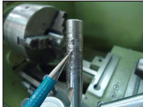
**ATENÇÃO-** Para confeccionar um furo com a broca helicoidal de haste cônica, você deve fixá-la diretamente no cone interno do mangote como se fixa a ponta rotativa, ou o próprio mandril. Lembre-se; cuidado para não cometer o grave erro de fixar a haste cônica no mandril, isso demonstra total falta de conhecimento com a ferramenta.
