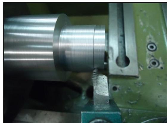
**3º PASSO :** Ao chegar no final, **DESENGATE as alavancas**, em outras palavras, desengate o carro **principal e** retorne a ferramenta, sem que a ferramenta se afaste da peça, ou seja, sem retirá-la da posição no anel graduado, deixando a ferramenta na mesma **referência, a exemplo de 2,0mm**. Em outras palavras, **NÃO** afaste a ferramenta pelo carro transversal, evitando assim que a ferramenta saia da referência no anel graduado, ficando pronta para um novo passo como já vinha fazendo.
