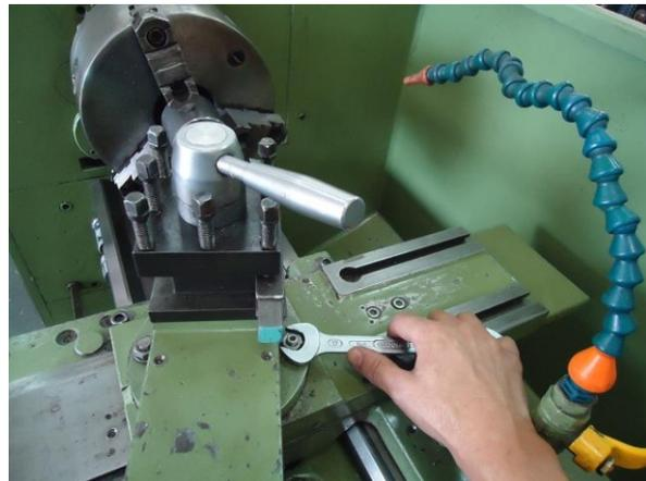
**Alinhe a ferramenta deixando-a paralela ao eixo principal a fim de facilitar a visualização do operador durante o torneamento.**
