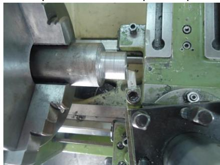
Ligue o TORNO e inicie a USINAGEM retirando pequenos passos até que a superfície fique PLANA e sem imperfeições. Ou seja, sem os degraus.
