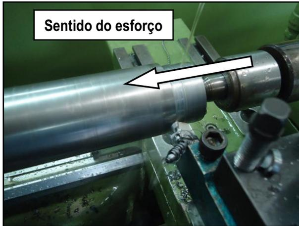
A ponta, conseqüentemente sairá do furo de centro quando a peça for para dentro da placa.
