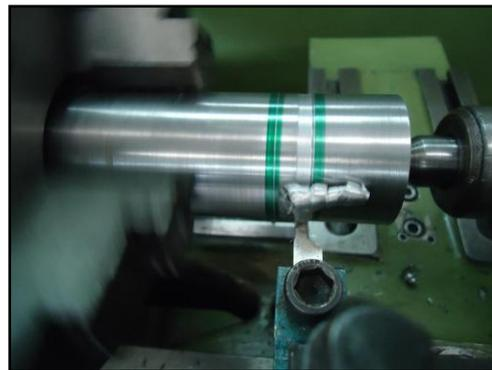
**Comentários** - Evite deslocar as três (3) voltas sem parar e de um só lado, dê uma volta e afaste a ferramenta, desloque-a para outro lado do canal e repita a mesma volta, principalmente se o cavaco não se desprender com facilidade, penetre a ferramenta alternando os lados do canal a fim de diminuir o esforço e assim evitar maior atrito da ferramenta com as paredes do canal. Use refrigeração constante
