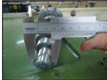
Nas Aulas 11 e 12 aprendeu o torneamento de medidas de diâmetro e de comprimento, ou seja, torneare rebaixos.
