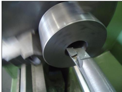
**RECORDANDO** - Fique atento na escolha da ferramenta a fim de evitar vibrações, além da ferramenta ser a mais grossa possível, deve ser fixada observando o comprimento à tornear, em outras palavras, fixar o mais CURTO possível. Alinhe os calços e proteja a ferramenta.
