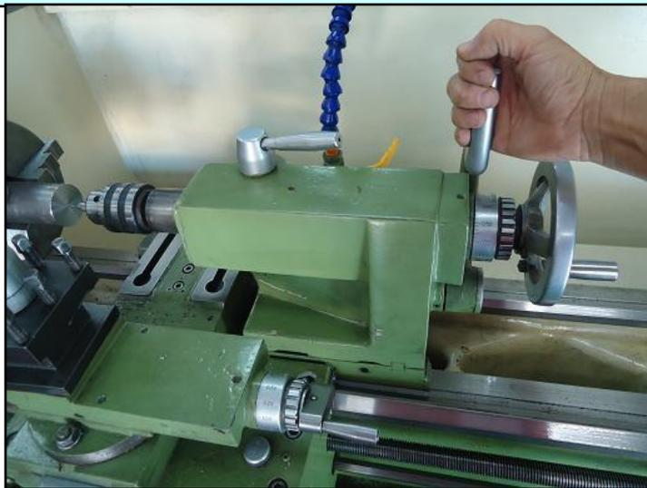
**8º Passo** - Selecione a rotação adequada com base no diâmetro da **broca de centro** e ligue o torno.
