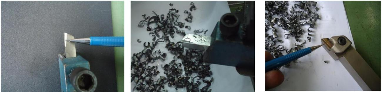
11º Retorne a ferramenta pelo próprio carro principal sem afastá-la da peça, ou seja, sem retirá-la da posição no anel graduado, deixando a ferramenta na mesma **referência de 2,0mm**. Em outras palavras, **NÃO** afaste a ferramenta pelo carro transversal, estando pronta para um novo passo. A ferramenta voltará riscando a superfície o que é normal.
