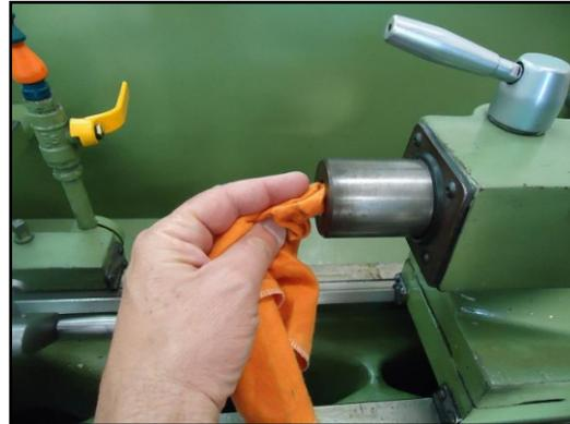
**4º Passo** - Lembre-se de deixar o mangote para fora do cabeçote, um comprimento suficiente para a fixação do mandril da mesma forma que foi deixando para a fixação da ponta rotativa, ok?!
