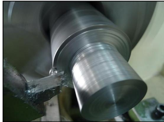
**PRECAUÇÃO** – neste momento evite retirar mais de 0,3mm por passo, caso seja necessário, trave o carro principal evitando assim que a ferramenta afaste no momento do TORNEAMENTO. O que é natural quando é retirado muito material com o carro superior. Porém quando retirar pouco material não é necessário travar o carro, ok !
