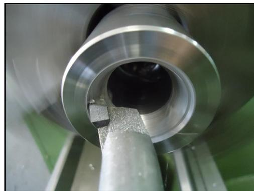
Desligue o torno, verifique o formato correto do cone e dê novos passos, controlando a medida com o paquímetro e verifique o grau de acabamento desejado.
