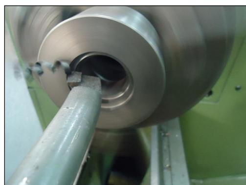
**7º - PASSO** - Desligue o torno, afaste a ferramenta através do carro principal e faça a verificação da medida com as orelhas do paquímetro. Havendo necessidade de dar novos passos, repita o mesmo procedimento aplicado no TORNEAMENTO EXTERNO.
