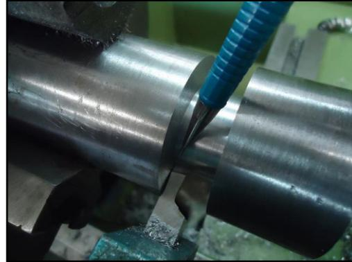
**15º PASSO** – Verifique a medida de abertura e quantos décimos faltam para a medida final em nosso exemplo é 15,00mm. Obs: Memorize o valor do anel graduado para no final retirar os décimos finais no diâmetro do canal.
