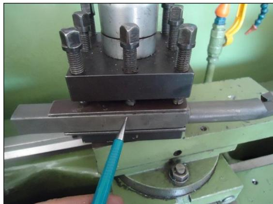
**PRECAUÇÃO II** – Outro cuidado que deve ser tomado ao fixar uma ferramenta de torneamento interno é em relação ao alinhamento dos calços. Evite deixá- los **desalinhados** porque pode ocorrer que durante o torneamento; ao deslocar a ferramenta, o calço possa **tocar e roçar** na peça antes que a ferramenta faça seu percurso e atinja seu comprimento desejado. Caso aconteça do calço roçar na peça em movimento, gerará um som assustando-o .
