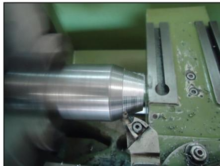
**OBSERVAÇÃO** - Alguns livros técnicos sobre usinagem destacam a importância de a ferramenta estar na altura de centro no torneamento cônico, porém apenas exigir não basta, temos que entender o porquê desta exigência até porque sabemos que há situações que a ferramenta pode ficar acima do centro. Precisamos entender mais sobre isso vamos a mais uma explicação inédita! Agora vamos aos exemplos práticos para que você possa entender com clareza assuntos relacionados à altura da ferramenta.
