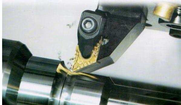
Pastilhas intercambiáveis possuem este nome porque podem ser substituídas quando apresentam algum tipo de desgaste; são fixadas por parafusos e outros acessórios. Essas PASTILHAS são de alta velocidade de corte para tornear e podem chegar até VC = 300M/min.
