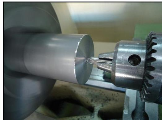
Fazer furo de centro é confeccionar um pequeno furo (orifício) com dimensões e formato específicos, utilizando de uma ferramenta chamada BROCA DE CENTRO. As dimensões do furo variam conforme a penetração da broca de centro na peça
