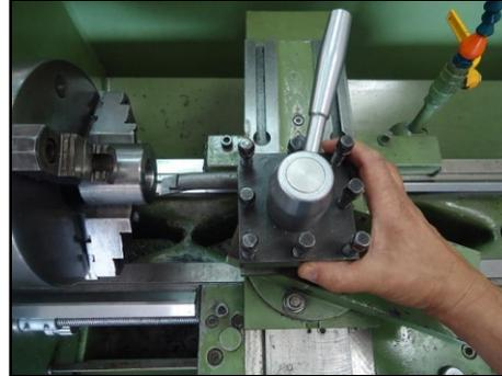
Trave o castelo e posicione a ferramenta. Prepare a RPM, ligue o torno e inicie o torneamento com avanço manual uniforme usando as duas mãos.
